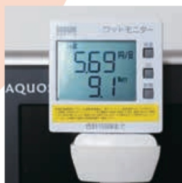
■リモコンで電源をオフにした状態です。待機電力 9W/h です。
